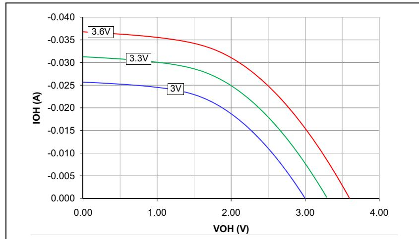
**FIGURE 32-2: V<sub>OH</sub> – 4x DRIVER PINS**
