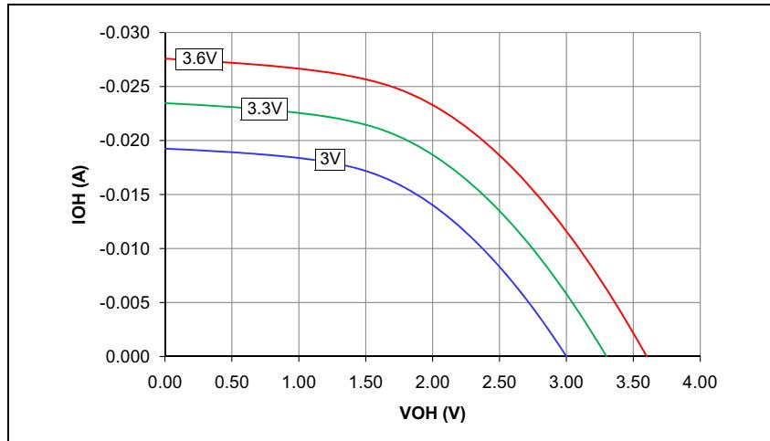
**FIGURE 32-4: V<sub>OH</sub> – 16x DRIVER PINS**
